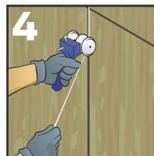
Colocar el CREST Boquifom® en la junta a la profundidad deseada o especificada, introduciéndola a presión.
