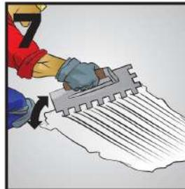
**7** Inclinando la llana con la sección dentada en un ángulo de 60° de la superficie, en forma lineal sobre el adhesivo recién aplicado, evitando hacer rayado en forma de abanico.
