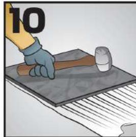
**10** Golpear las losetas con un mazo de hule levemente del centro de la loseta hacia afuera para sacar el aire y asegurar su contacto con el adhesivo. Verifique la correcta nivelación de las losetas.
