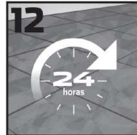
**12** Una vez terminada la instalación, será necesario esperar 24 horas para juntar emboquillar (este tiempo puede variar por las condiciones de clima).
