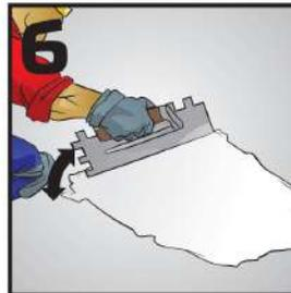
**6** Aplique una capa de adhesivo sobre el sustrato utilizando la parte lisa (plana) de la llana sosteniéndola en un ángulo de 60° de la superficie.
