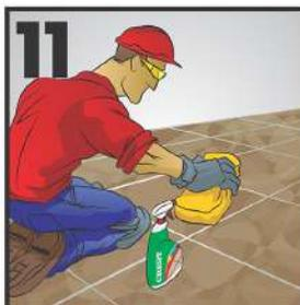
**11** Limpie los residuos de adhesivo una vez terminada la instalación con una esponja o trapo húmedo. Remover el exceso de adhesivo en las juntas para tener por lo menos una profundidad en la junta de 2/3 disponible para emboquillar.
