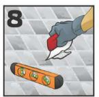
Remueva el exceso de BoquiCREST Glass, EL EXCEDENTE ES REUTILIZABLE. Por ningún motivo agregue AGUA al producto, ya que esto inhibiría las propiedades del URETANO. La superficiede BoquiCREST Glass puede ser nivelada o enrasada al borde de la
