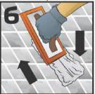
Con una llana de esponja dura y bordes afilados para uretano, distribuya el BoquiCREST Glass en un ángulo de 45º respecto a la superficie, presionando con pases de vaivén para que la mezcla penetre en los espacios o juntas.
