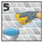
Para obtener mejores resultados, humedezca previamente la superficie de las losetas con una esponja húmeda (casi seca), cuidando de no dejar agua estancada en la superficie ni en las juntas.
