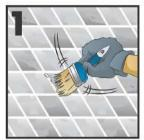
BoquiCREST Glass deberá ser aplicado al menos 24 horas después de la instalación de la loseta cerámica o la indicación según el adhesivo usado, cuidando que ya esté seco y las losetas bien fijas.
