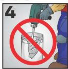
NO DILUYA, No utilice un mezclador o taladro mecánico para el mezclado pues afecta el desempeño del producto. No aplique este producto por el método tradicional de junteado y emboguillado.
