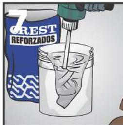
7 Revuelva bien hasta formar una mezcla homogénea. Deje reposar la mezcla 5 minutos. Para lograr una mezcla homogénea se recomienda un mezclador eléctrico de bajas revoluciones.
