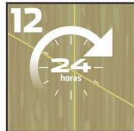
Después de haber juntaado o emboquillado la instalación es necesario esperar 24 horas adicionales para abrir al tráfico ligero.
