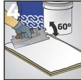
Coloque el adhesivo en la parte posterior de la loseta utilizando la parte plana de la llana sosteniéndola en un ángulo de 60° de la superficie.
