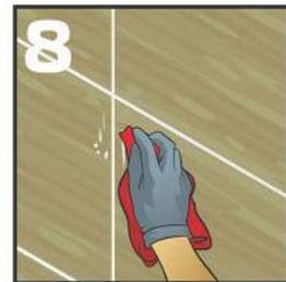
Limpe los residuos de adhesivo una vez terminada la instalación con una esponja o trapo húmedo.
