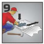
Coloque las piezas procurando moverlas ligeramente hacia arriba y abajo en sentido perpendicular al rayado del adhesivo y golpe levemente con el mango de la llana o con un mazo de hule para asegurar su contacto con el adhesivo.
