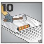
Verifique su nivelación correcta. Cheque periódicamente las piezas verificando lograr un área de contacto con la loseta de al menos un 85%.
