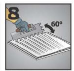
Coloque el adhesivo en la parte posterior de la loseta utilizando la parte plana de la Ilana sosteniéndola en un ángulo de 45º de la superficie, y después con la sección dentada de la Ilana inclinada a 60°.
