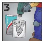
Revuelva bien hasta formar una mezcla homogénea. Deje reposar la mezcla 10 minutos. Para lograr una mezcla homogénea se recomienda un mezclado eléctrico de bajas revoluciones.
