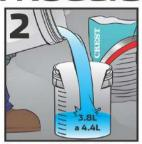
Vacíe en un recipiente 3.8 a 4.4 litros de agua limpia. Agregue un bulto de CREST Pega Marmol (20 kg/44lbs.). Deje reposar 5 minutos.
