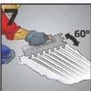
Con la parte dentada de la llana, peine en forma lineal el adhesivo aplicado para formar una cama de al menos 3mm.
