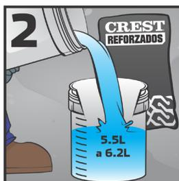
**2** Vacíe en un recipiente 5.5 a 6.2 litros de agua limpia. Agregue lentamente un bulto de CREST EuroBond LOT (20 kg/44lbs.). Deje reposar 5 minutos.
