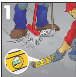
1 La superficie debe estar limpia, libre de polvo, aceite, cera o impurezas que impidan adherencia. Asegúrese de que la losa tenga pendiente para el agua pluvial.
