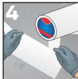
4 Antes de que se seque el ImperCrest Cemento Plástico coloque una malla de refuerzo en puntos críticos como fisuras, chaflanes, esquinas, domos, etc. (el tamaño debe ser mayor al área a reforzar, 15 cm mínimo).
